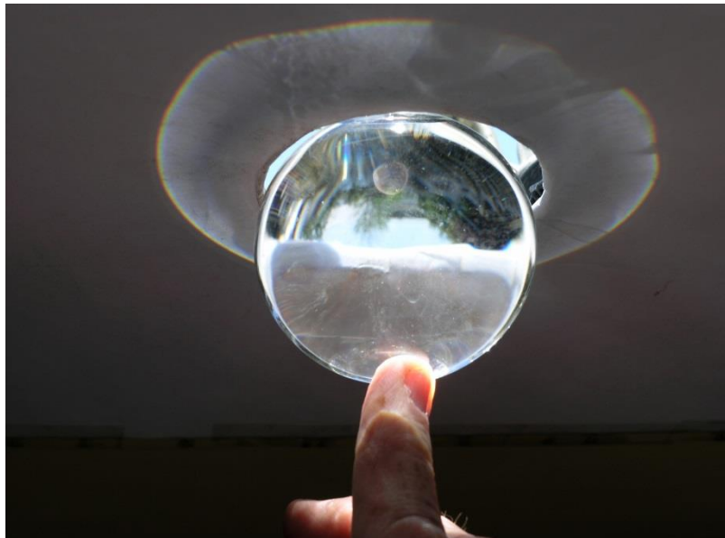
המתקן של תיאודוריד : צנצנת מים כדורית, המייצגת טיפת מים כדורית
